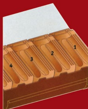
Posa delle tegole marsigliesi a giunti non sfalsati per file orizzontali
