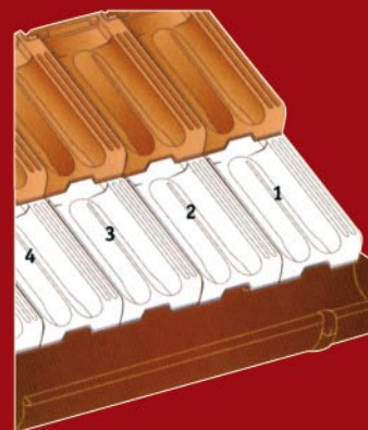
Posa delle tegole marsigliesi a giunti non sfalsati per file orizzontali
