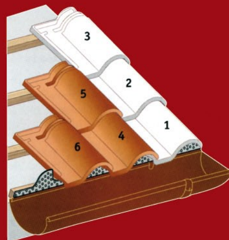
Successione della posa delle tegole portoghesi secondo lo schema diagonale
